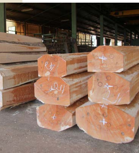
Quartelots préparés pour le tranchage – Tropical Bois, Adzopé (Côte d'Ivoire).
